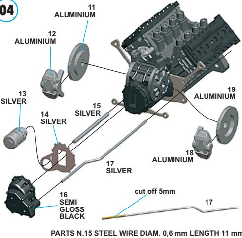
PARTS N.15 STEEL WIRE DIAM. 0,6 mm LENGTH 11 mm
